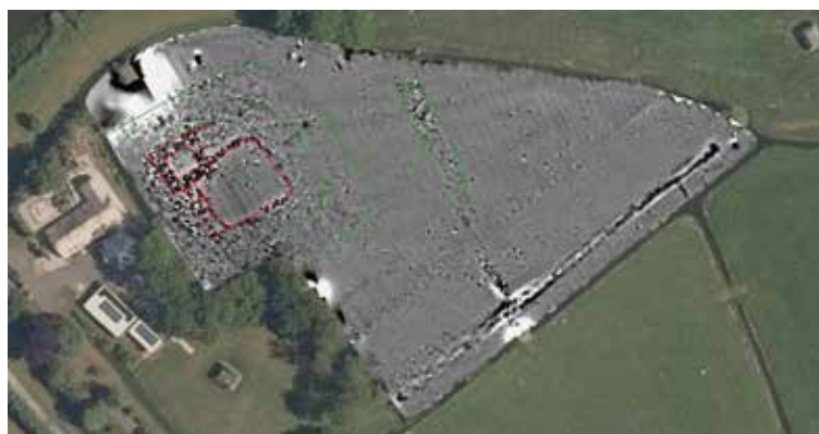
10 MAG-data. Kaart Ferry van den Oever, Saricon BV, 2023. In rood de contrastverschillen die te maken hebben met bebouwing, in groen andere opvallende begrenzingen van contrastverschillen.
